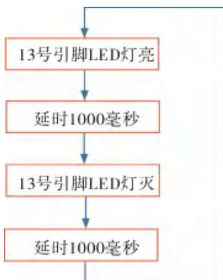
图9-5 闪烁LED流程图
