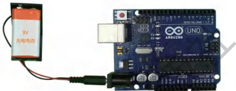
图9-6 Arduino板独立工作
