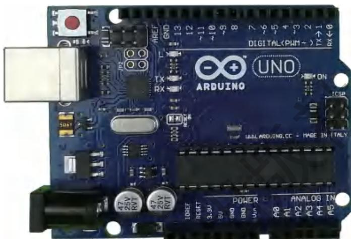
图9-1 Arduino UNO 控制板
